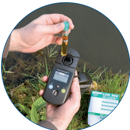
Bild 7: Mät mobilt ute i fält med en knapptryckning: Enparametermätaren POCKET Colorimeter II för nybörjare.
