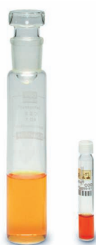
Bild 4: För kyvett-tester används 90% mindre mängd kemikalier än traditionella titreringsmetoder.
