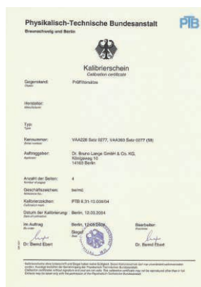
Bild 12: Officiellt godkänt: Kalibreringscertifikat för HACH LANGE kontrollfiltersats LZW 537 för kontroll av fotometern.
