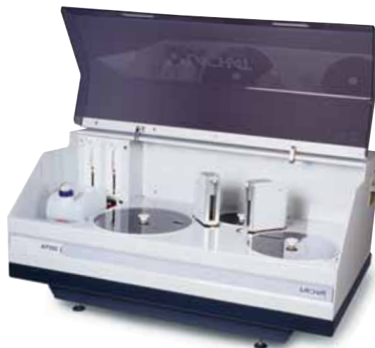
AP 300 DISKRET: Helautomatisk jonanalysator för miljöanalys, komplett med högkvalitetsreagenser klara för användning
