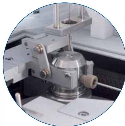
Den pneumatiska injektionsporten uppfyller partikeltestet enligt ISO 8254 och DIN EN 1484
